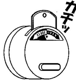
カードの印刷面を手前にし、カード挿入口に「カチッ」と音がするまでカードを挿入して下さい。
