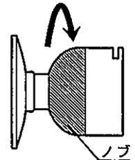
**!** カードを抜いた後は、カードシリンダーが空回りする事をご確認下さい。異物等の混入により、鍵の効力が維持出来ない場合がございます。施錠後は、カード挿入口を下に向ける様にして下さい。挿入口を下に向ける事で防滴性防犯性が高まります。
