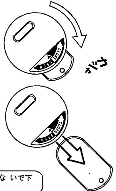
**!** カードを挿入し必要以上に施錠または解錠方向に強く回転させないで下さい。故障の原因となる恐れがございます。
